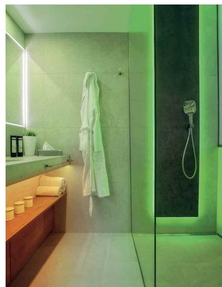
**Die Lichtprofile können auch im Duschbereich verwendet werden, wenn sie über die entsprechende Schutzklasse verfügen.**
