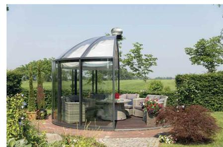
Immer gut belüftet: Die zwei Halbschalen des Pavillons lassen sich stufenlos mit- oder gegeneinander verschieben.
