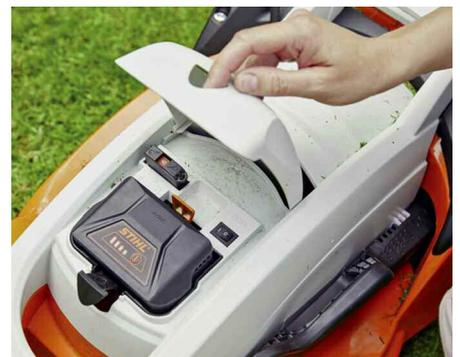
Der Akku wird für die Winterpause aus dem Rasenmäher entnommen und separat an einem trockenen und frostsicheren Ort gelagert.
