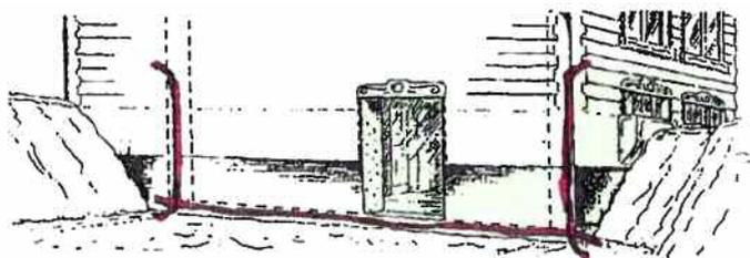
**Auch bei dem speziellen Problem des Anschlusses zwischen Alt- und Neubau kommt der Injektschlauch zum Einsatz.**
