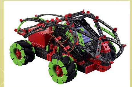
**Mit dem Baukasten können Tüftler Omniwheels-Fahrzeuge konstruieren, die sich in sämtliche Richtungen bewegen.**
